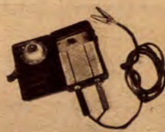
Átfúrt zseblámpatok műanyagcső szigeteléssel
