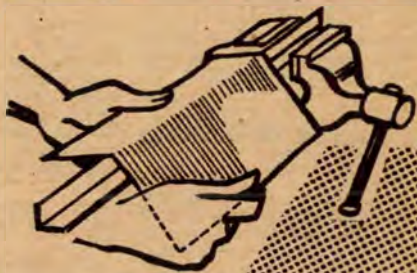
Igy hajlítható a celluloid-lemez
